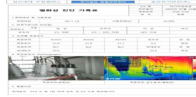
적외선 열화상 측정결과 (양호)
